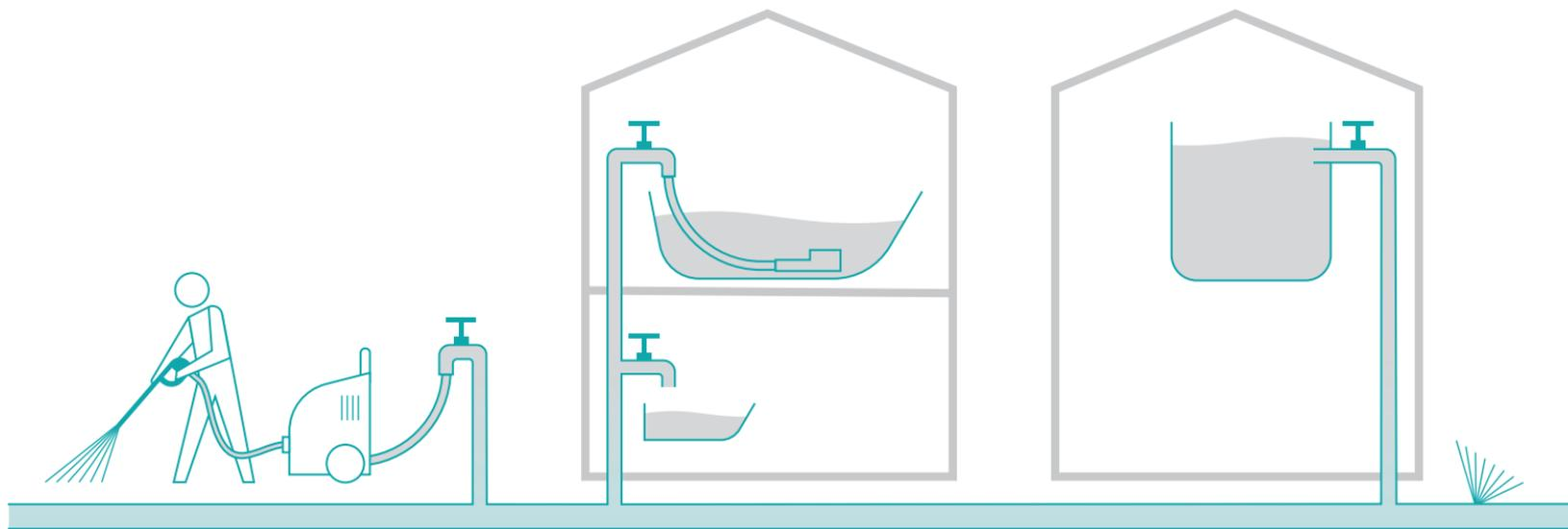
Rückfluss durch ein Gerät mit Überdruck (Hochdruckreiniger)
